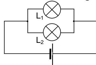
**Versuch 1** **Gleiche** Lampen L<sub>1</sub> und L<sub>2</sub>
