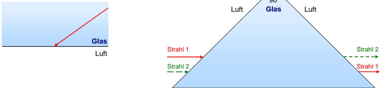
4. Zum Schluss wird es rätselhaft: Welche durchsichtigen Glaskörper befinden sich unter den Kästen? Zeichne eine mögliche Lösung mit dem ungefähren Strahlengang in dein Heft!
