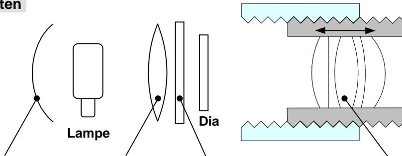
Der **Hohlspiegel** reflektiert und bündelt das nach hinten gehende Licht der Lampe nach vorne zum Dia.
