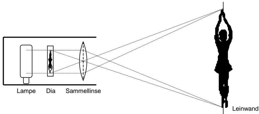
Die Rückseite des Dias wird von einer Lampe gleichmäßig beleuchtet. Die Farbteilchen auf dem Dia leuchten auf, das Dia wird zu einem leuchtenden Gegenstand. Von diesem Gegenstand wird mit Hilfe einer Sammellinse ein vergrößertes, reelles Bild auf der Leinwand erzeugt.
