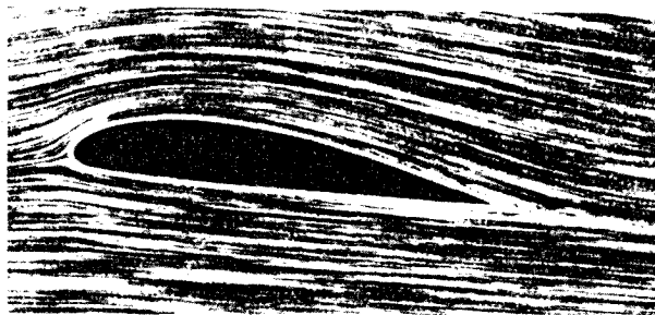
Abb. 2-5 "Gesunde" Umströmung eines Flügelprofils (aus [12])
