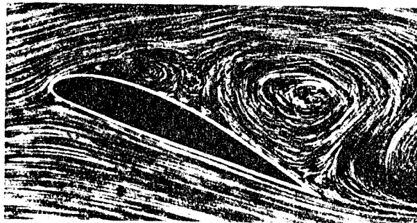
Abb. 2-8 Abgerissene Flügelumströmung (aus [12])
